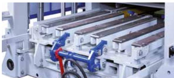
Надежная система уплотнения ZENITH с 3-частичным вибростолом гарантирует наивысшее качество продукта. Шесть не требующих дополнительного обслуживания вибраторов с регулировкой частоты, легко могут устанавливаться на разные требования продуктов.
