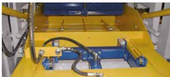
Загрузочная тележка основного бетона снабжена гидравлически приводимыми в действие колосниками. Они способствуют быстрому и равномерному заполнению формы бетоном и таким образом повышают мощность машины.
