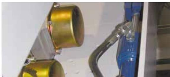
Проверенное в работе устройство быстрой замены штампа и электрическая перестановка устройства загрузки облегчают замену формы. Сокращается время, которое позволяет нам быстрый старт вибропресса в производство.
