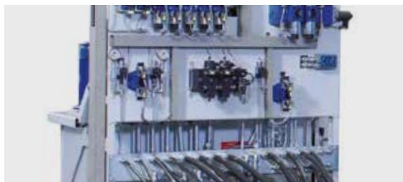
Компактная гидравлика среднего давления оборудована 3 мощными насосами. Главные движения машины управляются с помощью пропорциональной техники и таким, образом могут быть оптимизированы на разные продукты.
